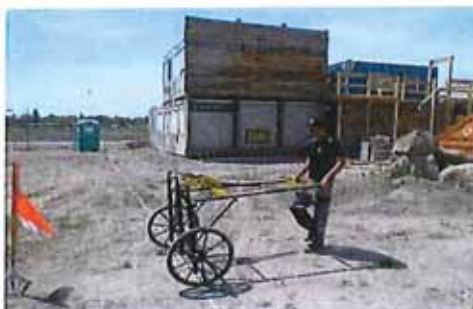
MULTI-CAT für Großflächen! FOERSTER - Differenzmagnetometer Mehrkanalsystem! Bis zu 4 Sonden bei 0.50m Spurbstand!
