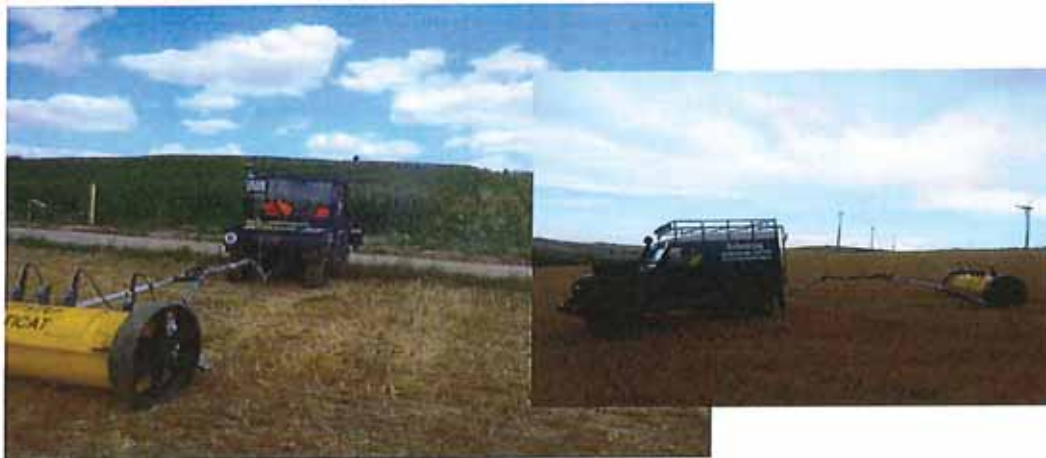
MULTI-CAT für Großflächen! FOERSTER - Differenzmagnetometer Mehrkanalsystem! Bis zu 4 Sonden bei 0.50m Spurbstand!
