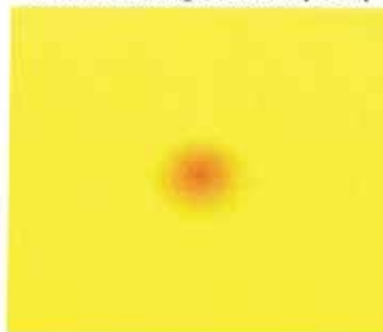
Signatur Objekt 0,25 m Durchmesser 2,5 m unter Magnetometer ( \pm 8 nT)
